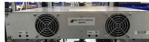
**El módulo rectificador RT35 (35 kW)
